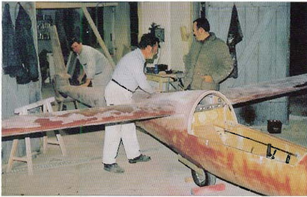
Die Elfe S4 im Rohbau, v.l.: Kurt Schmieder Roger Russmann, Horst Winker
